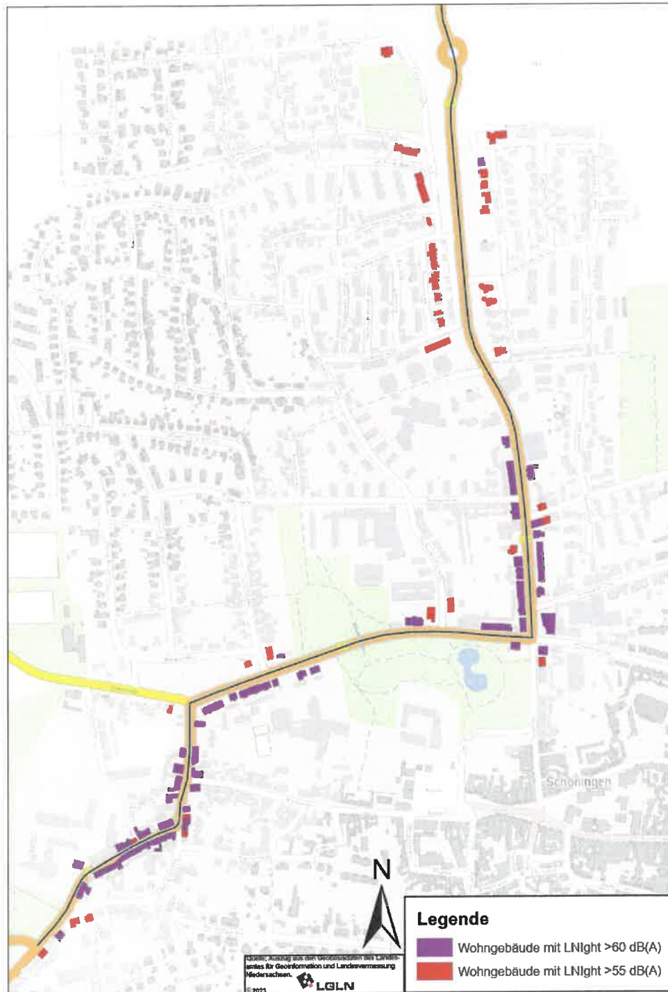
Abbildung 1: Von Umgebungslärm belastete Wohngebäude an der B244 in Schöningen Kernstadt
